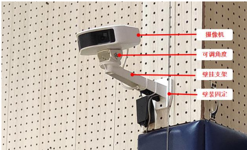
图 4-3 固定款壁挂安装
