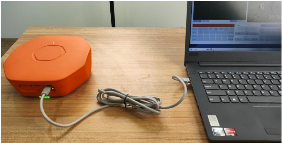
图 2.1 网线直接方式
